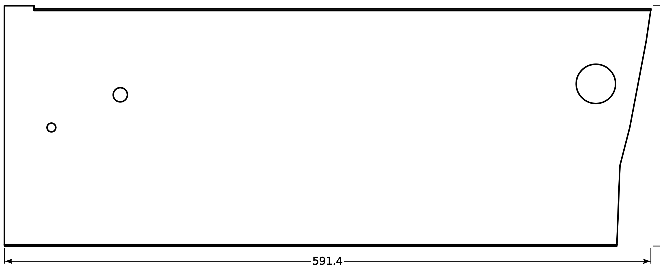
Поз. 4. Пол, 1 шт. Лист 10 АМг5 ГОСТ 21631-76 plate-04.step, .dxf
