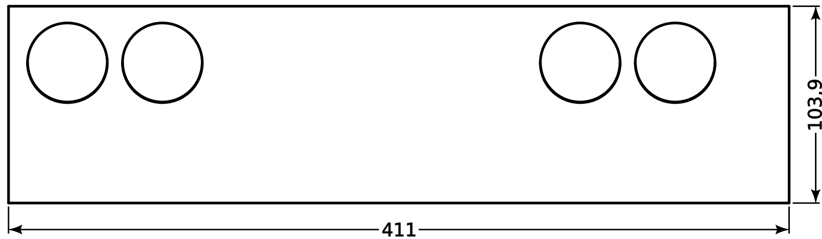
Поз. 6. Стенка ресивера левая, 1 шт. Лист 5 АМг5 ГОСТ 21631-76 receiver-06.step, .dxf
