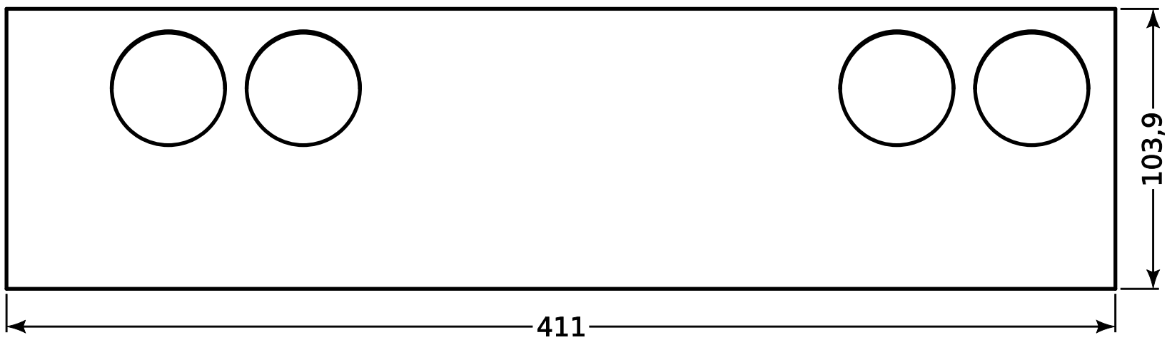
Поз. 5. Стенка ресивера правая, 1 шт. Лист 5 АМг5 ГОСТ 21631-76 receiver-05.step, .dxf
